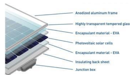
شکل ۳. اجزاء یک ماژول خورشیدی فتوولتائیک
